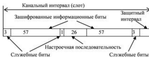
Рис. 3.5 Структура канального интервала стандарта GSM
