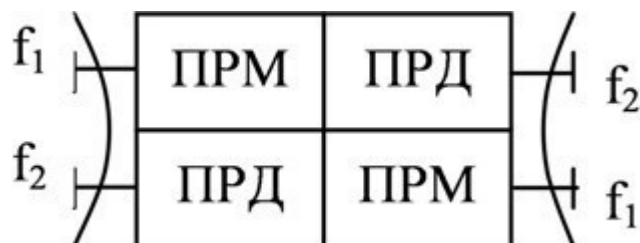
Рис. 1.3 Структурная схема дуплексной ПРС
