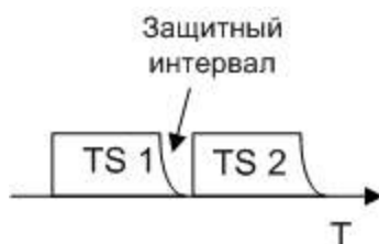
Рис. 4.2. Защитные интервалы в цикле TDMA
