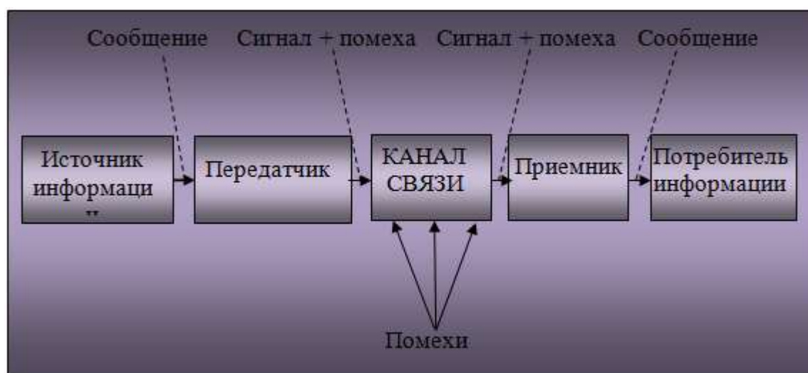
Рис. 1.14. Обобщенная структурная схема автоматизированной системы передачи информации
