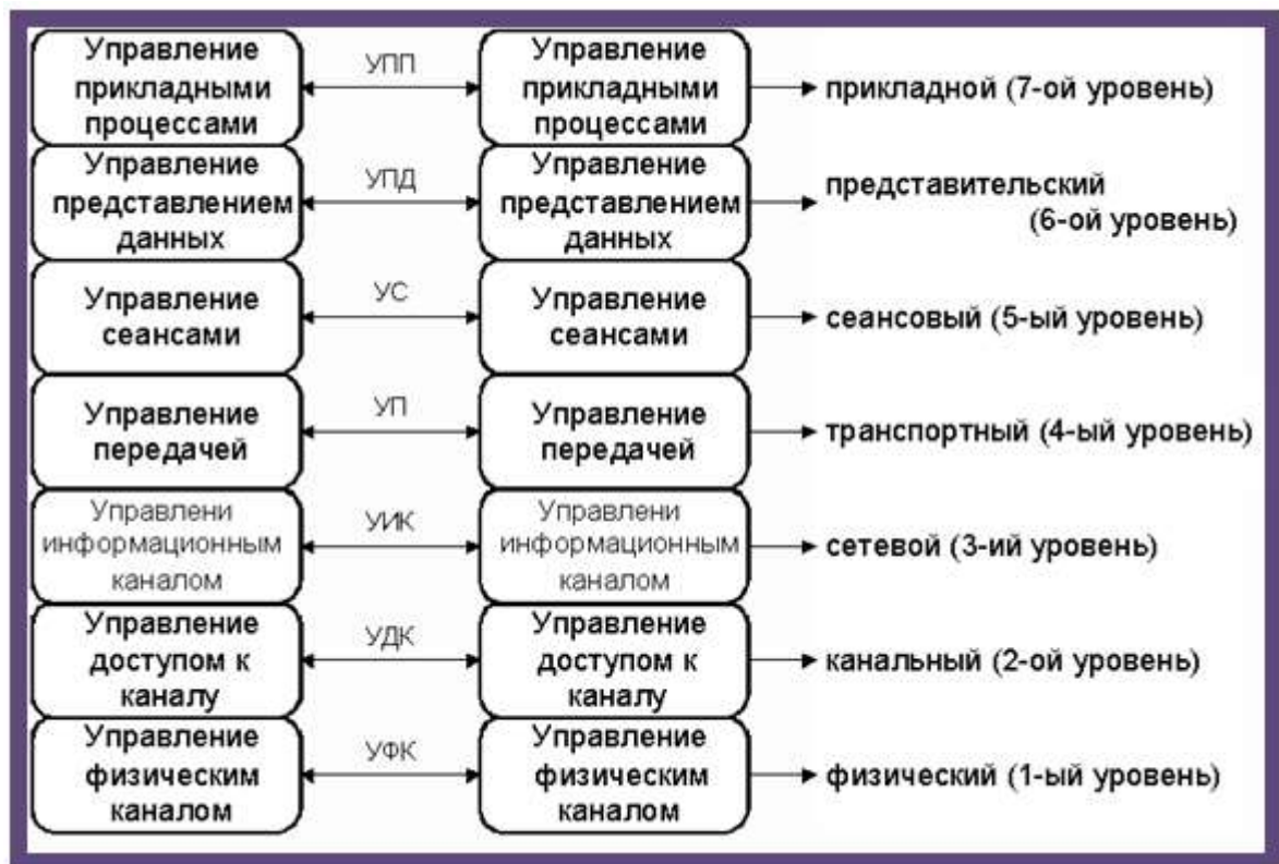
Рис. 1.20. Уровни управления и протоколы модели OSI
