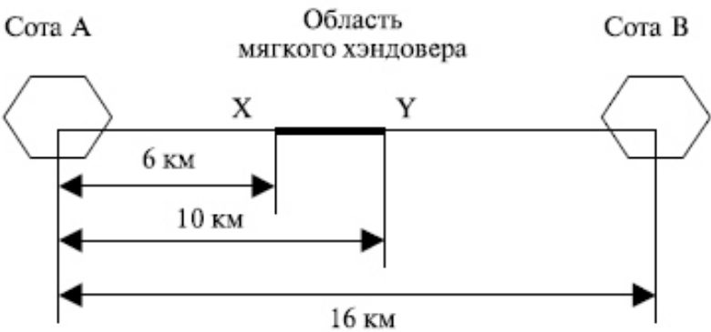
Рис 2. Определение окна SRCH_WIN_A для мягкого хэндовера
