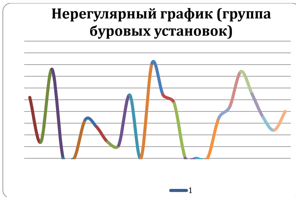
Рис.4. Пример нерегулярного графика электрических нагрузок в нефтегазодобыче
