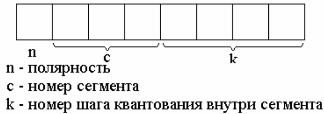
Рис. 5.3 — Формат восьмиразрядной ИКМ комбинации с компандированием по закону \mu = 255
