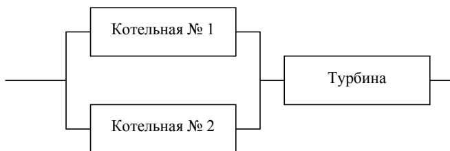
Рис. 9. Упрощенная принципиальная схема энергоблока
