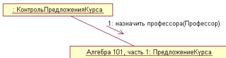
Рис. 4. Обозначения объектов, связей и сообщений, применяемые в диаграммах сотрудничества
