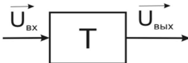
Рисунок 10. Представление радиотехнической системы в виде «черного ящика».
