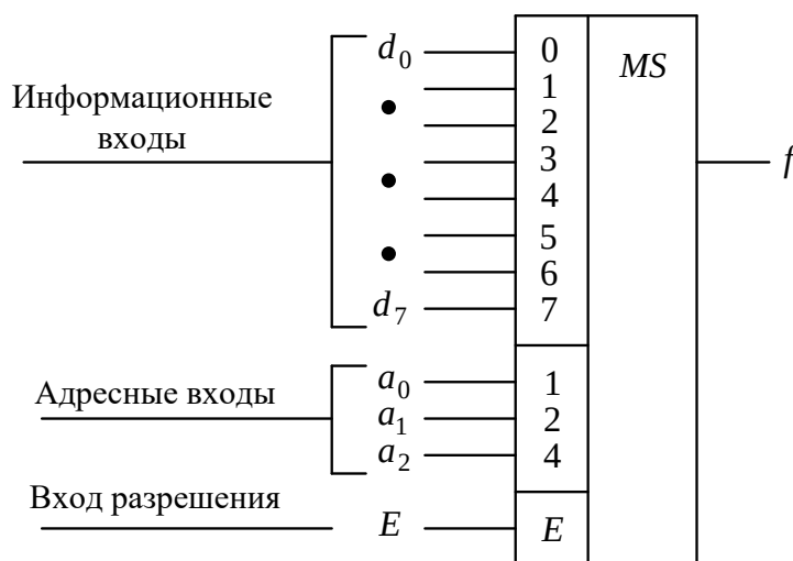
Рис. 6.2 – Полный мультиплексор 8-1
