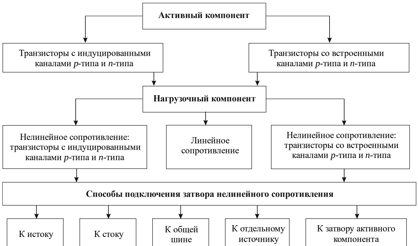
Рис. 4.12 – Формирование ключевых схем на МДП-транзисторах
