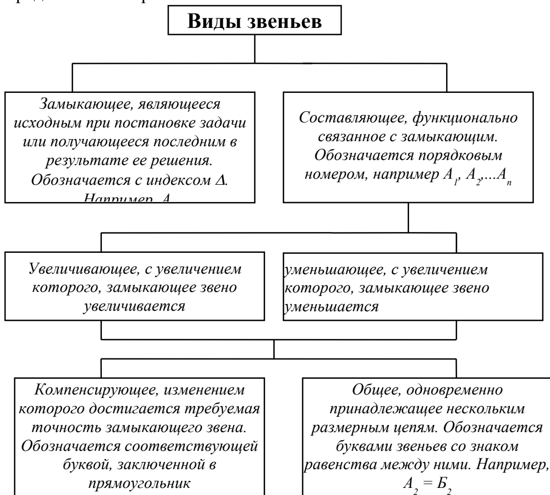
Рисунок 29– Классификация звеньев размерных цепей
