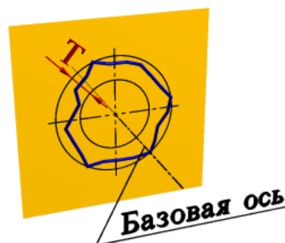
Рисунок 52- Поле допуска радиального биения
