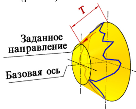
Рисунок 60-Поле допуска биения в заданном направлении
