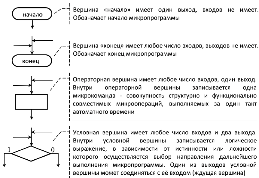
Рис. 3.2. Типы вершин граф-схемы алгоритма
