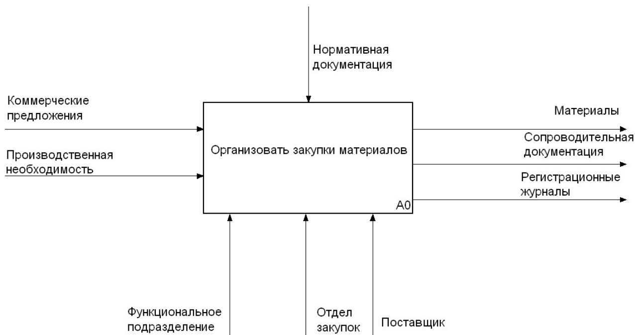
Рисунок 2. – Пример описания функциональной подсистемы в нотации IDEF0
