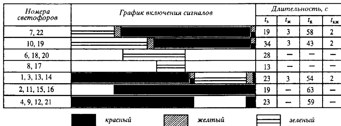
Рис. 6. Режим работы светофорной сигнализации: а - пофазный разъезд транспортных средств; б - управление движением по направлениям перекрестка
