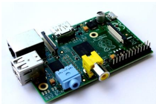
Рис. 2.10 – Одноплатный компьютер Raspberry Pi
