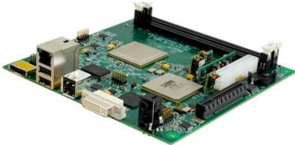
Рис. 2.9 – Системная плата компьютера с процессором «Эльбрус-2С+»
