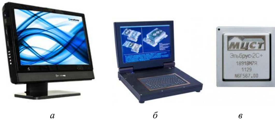
Рис. 2.8 – Моноблок Kraftway с процессором «Эльбрус-2С+» (а), защищенный ноутбук (б), процессор «Эльбрус-2С+» (в)
