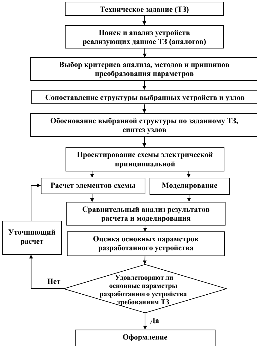
Рис. 1 – Порядок проведения работ
