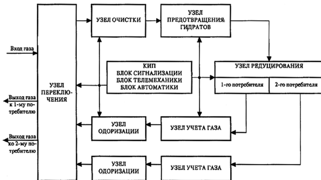
Рисунок 10.9 – Структурная схема ГРС с двумя потребителями
