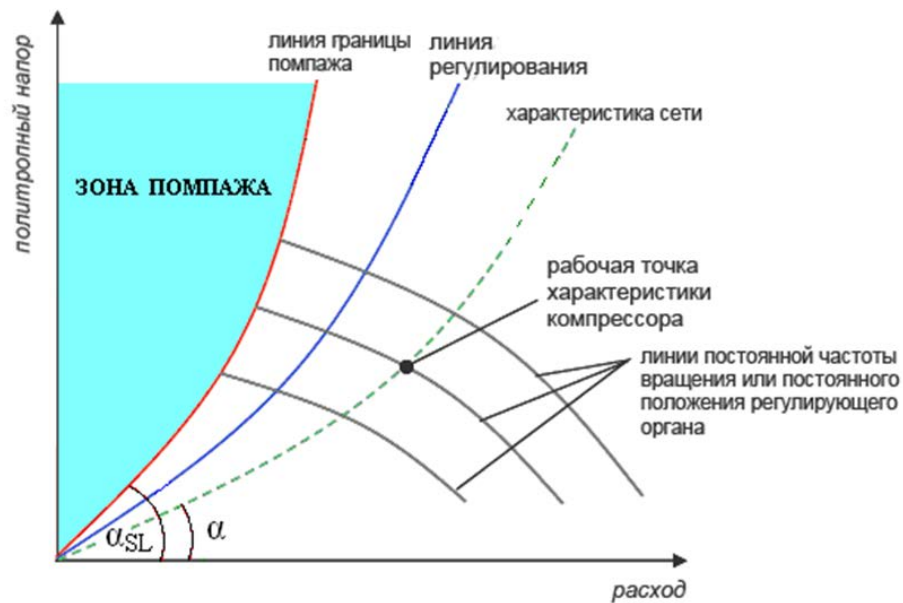
Рисунок 10.7 – Газодинамическая характеристика нагнетателя
