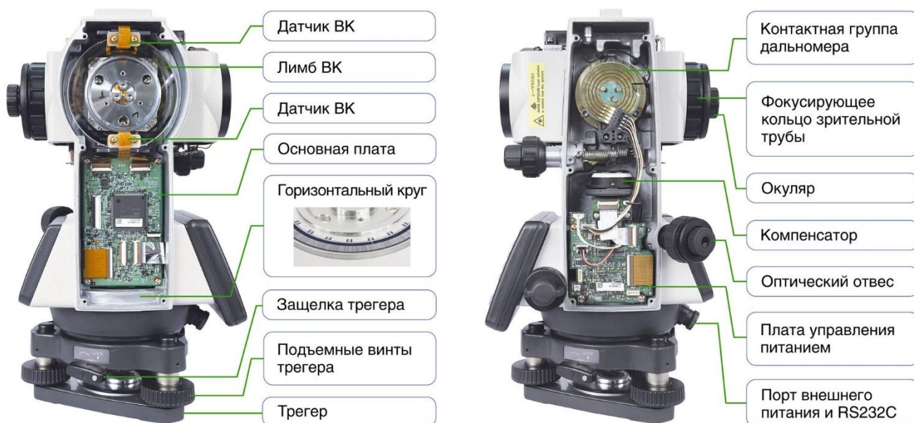
Рисунок 2.2. Электронный тахеометр в разрезах
