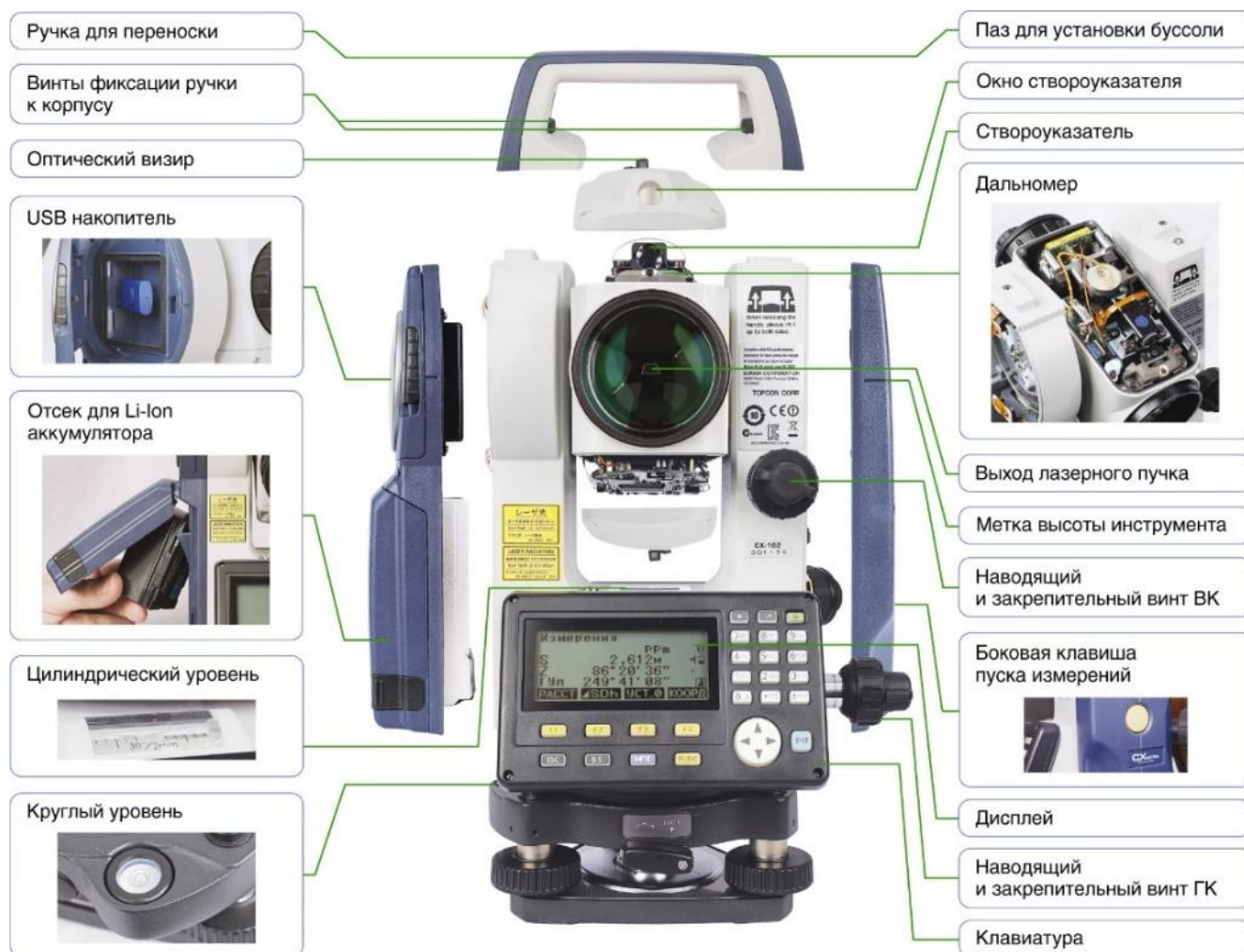
Рисунок 2.1. Схема внешнего устройства электронного тахеометра
